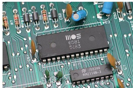
La tecnología de orificio pasante fue ampliamente utilizada en la fabricación de circuitos electrónicos antes de la aparición de la tecnología de montaje superficial (SMT - Surface Mount Technology). Aunque la SMT ha ganado popularidad debido a su
