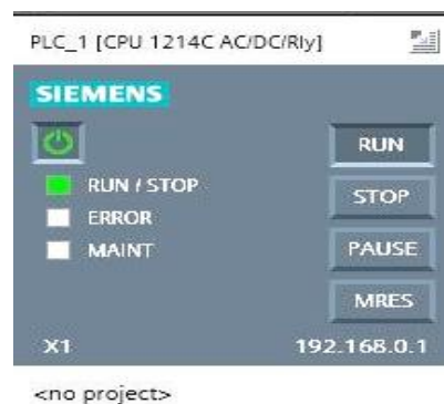
Figura 99 Ventana emergente del PLC funcionando
