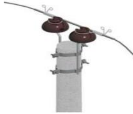
Figura17: Estructura aérea monofásica centrada angular
