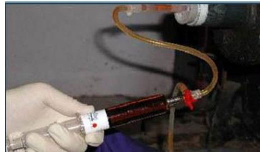
Figura 7: Toma de muestra de aceite. Fuente: (Santa, 2018)
