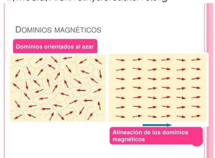
Figura 6 En esta figura se presentan dominios magnéticos orientados al azar (parte izquierda) y dominios magnéticos orientados ante la acción de un campo magnético externo.
