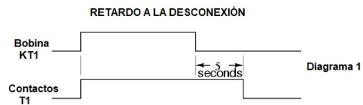
Figura 1.29 Diagrama de tiempo del temporizador Off Delay
