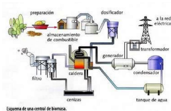
Figura 28 Esquema de funcionamiento de biomasa
