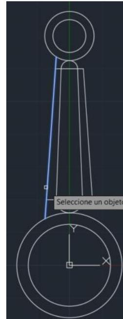
**Paso 9:** En el menú MODIFICAR, activamos en comando "EMPALME", para redondear las esquinas superiores e inferiores con un radio de 5 mm.
