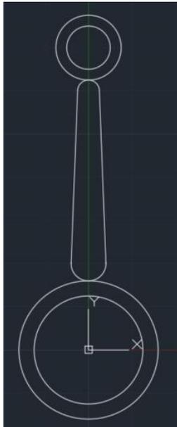
**Paso 7:** En los centros de los círculos de 4 mm y 2.5 mm, dibujamos una línea de 14 mm y otra de 8.5 mm respectivamente.
