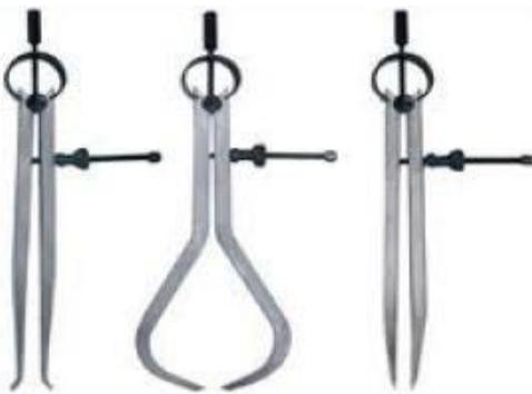
**Figura 19.** Compas de interiores, exteriores y recto
