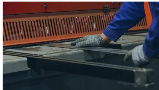
**Figura 27.** Corte con cizalla
