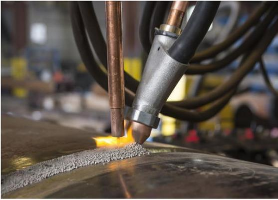
**Figura 50.** Soldadura por arco sumergido.
