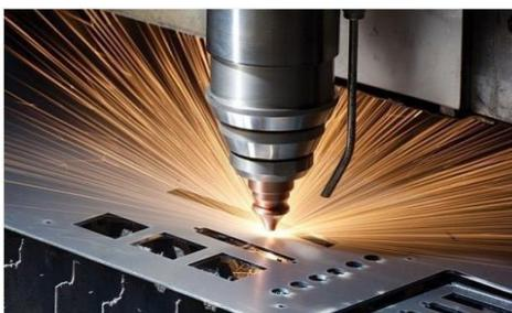
**Figura 25.** Corte por láser
