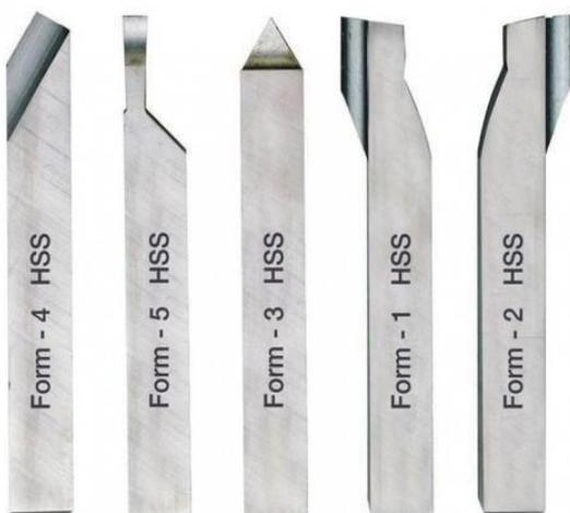
Fig. 6. Cuchillas de Torno
