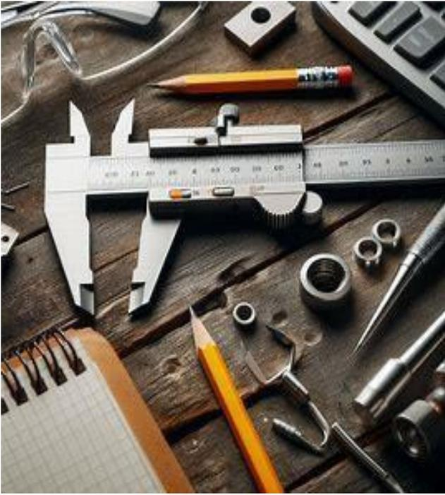
**Figura 7.** Calibre o pie de rey
