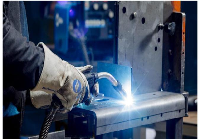
**Figura 48.** Soldadura MIG.
