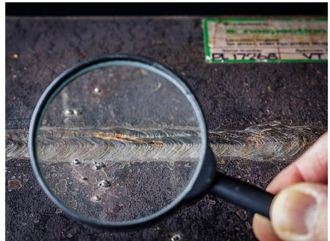
Figura 59. Inspección del cordón de soldadura.
