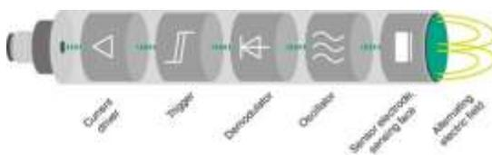
**Fig. 2.4.** Diseño de sensores capacitivos
